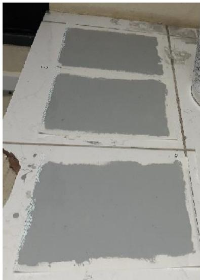
**Figura 13: Amostras depositadas sobre o filme de transparência e deixadas para o processo de cura à temperatura ambiente.**
