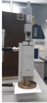
**Figura 9: Célula para ensaios dielétricos em materiais sólidos.**
