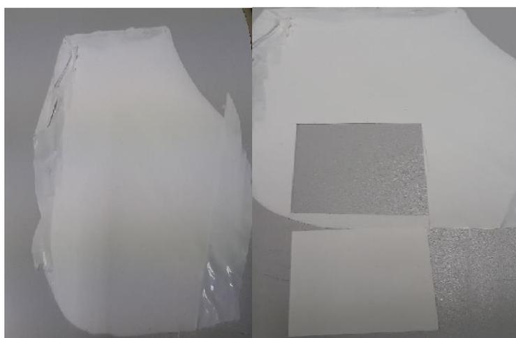
**Figura 14: À esquerda a amostra retirada do filme de transparência e à direita a amostra retirada recortada com as medidas necessárias para a realização dos ensaios.**
