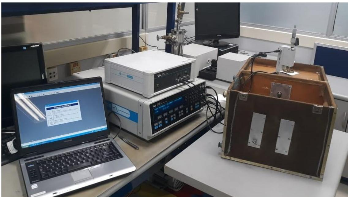
**Figura 16: Conjunto utilizado para realização da espectroscopia dielétrica, para obtenção da tangente de perdas.**
