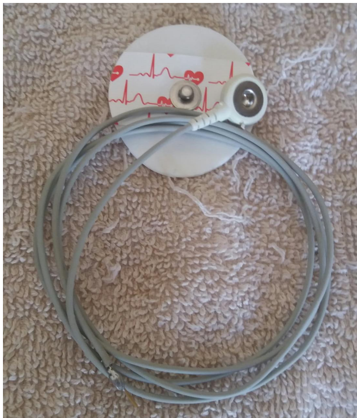
FIGURA 16 – CABO UTILIZADO PARA CAPTAÇÃO DE SINAIS DE EEG
