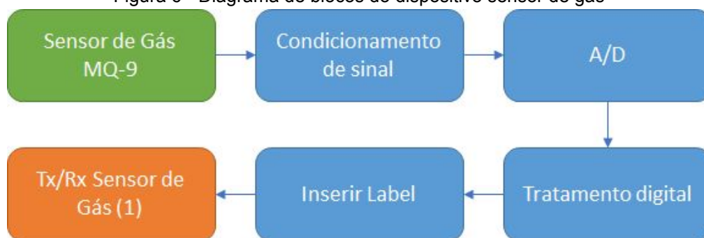
Figura 6 - Diagrama de blocos do dispositivo sensor de gás
