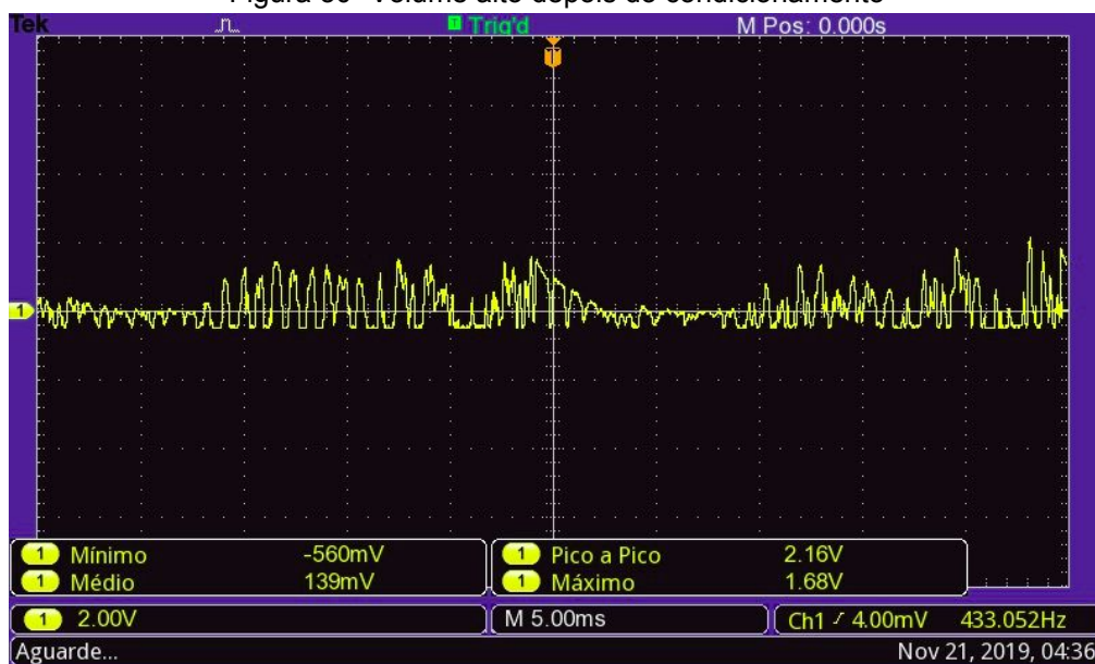
Figura 30- Volume alto depois do condicionamento
