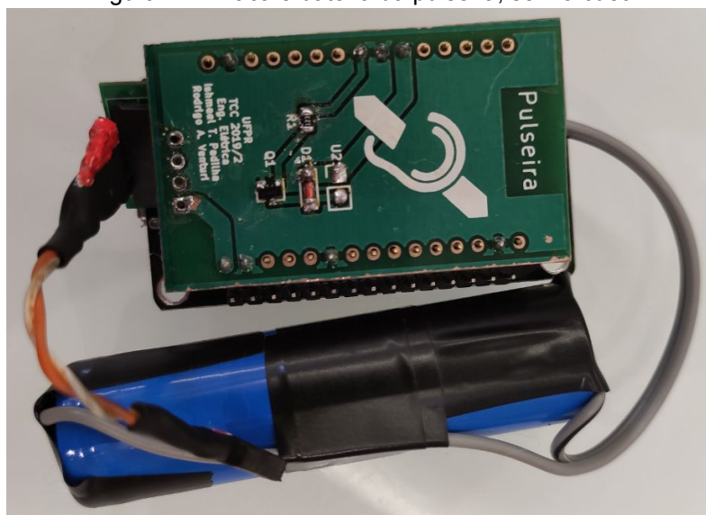
Figura 22 - Placa e bateria da pulseira, sem a case
