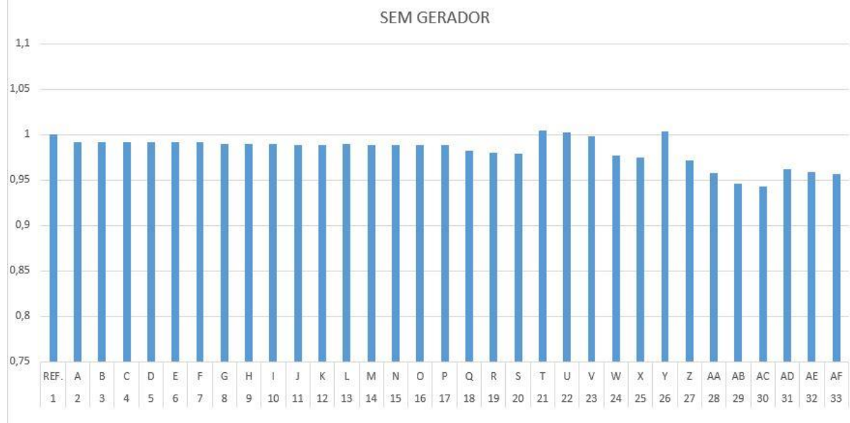
Figura 28: Valores de tensão em pu em cada barra do circuito considerando carga pesada sem geração de energia.
