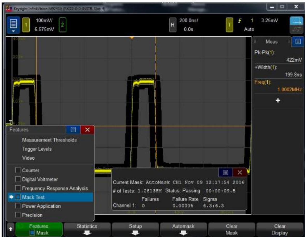
Figura 20 – Exemplo de teste de máscara.
