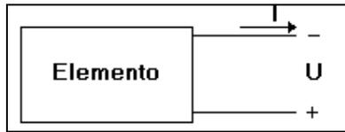
**Figura 1.3:** Convenção de elementos passivos.
