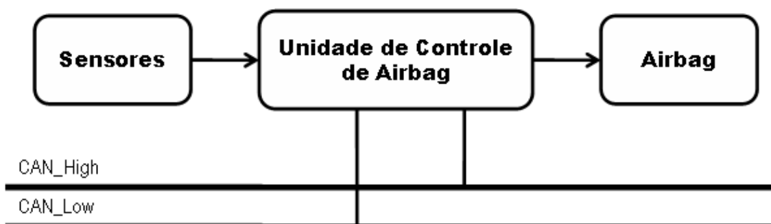
Figura 4 – Diagrama de blocos do sistema de airbag
