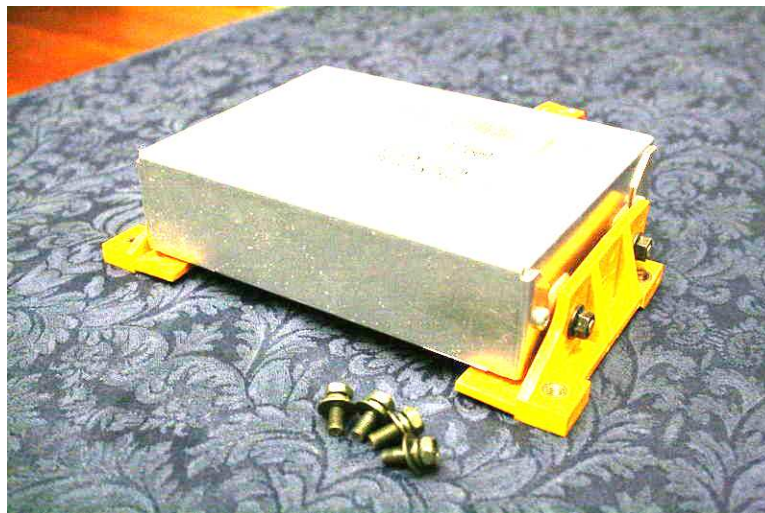
Figura 5 – ACU, unidade de controle de airbag
