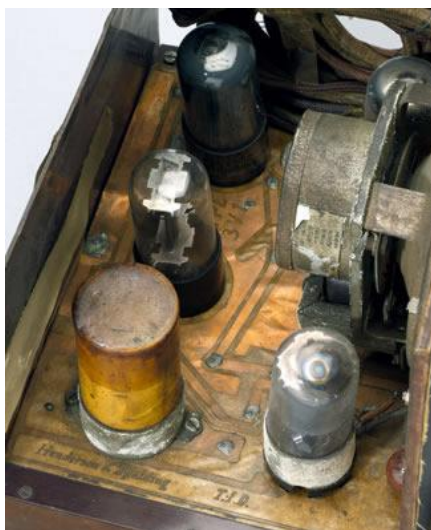
Figura 2: Capa da biografia de Paul Eisler, inventor do circuito impresso, e foto de um rádio construído por ele em 1946, utilizando circuito impresso semelhante aos atuais.
